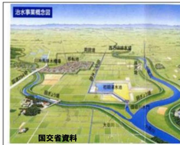
導き入れて溜め込み、洪水の危険が去った時点で小貝川に戻すことで、下流部への水量を減らし、小貝川全体の安全性を高める。母子島遊水地には、洪水時に約500万m<sup>3</sup>の水を溜めることができるようである。
